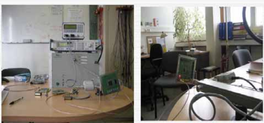
圖 5.4 直接功率注入法
