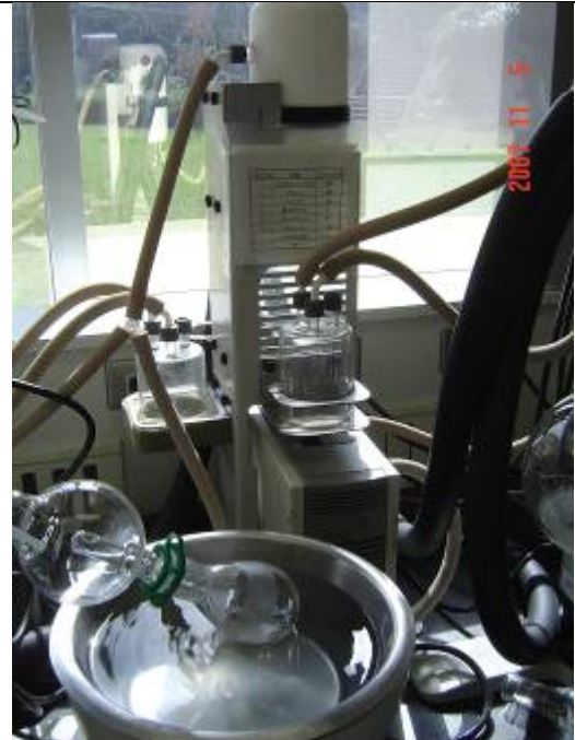
真空濃縮機—溶劑回收裝置使溶劑不致外溢
