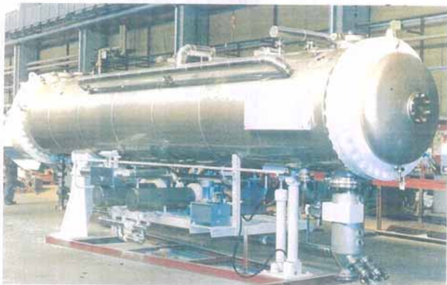
Ekstraktionsanlæg. Driftstryk: 16 bar.
