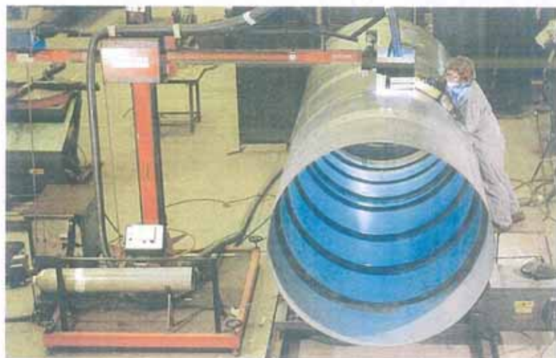
Automatisk rundevejseudstyr. Emnediameter: 3000 mm.
