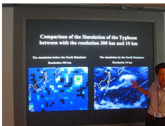
圖 24 簡報說明：圖為栗田昭宏先生針對以往颱風模擬進行比較，可從300km 格網的精度可大幅增加到 10km 格網的精度，顯示其優越的性能
