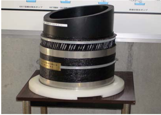
圖 6 駿河灣取水鎧裝鋼線之 HDPE 管及原水分水設施
