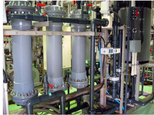
圖 7 駿河灣深層海水取水後脫鹽設備，下圖為說明圖
