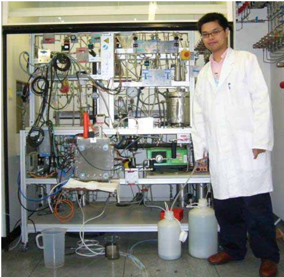
圖10. Forschungszentrum Jülich之堆疊電池組測試平台(1)
