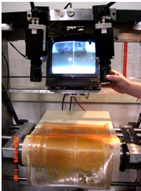
(透過儀器輔助，將凸版版模置放於 Plate Cylinder)
