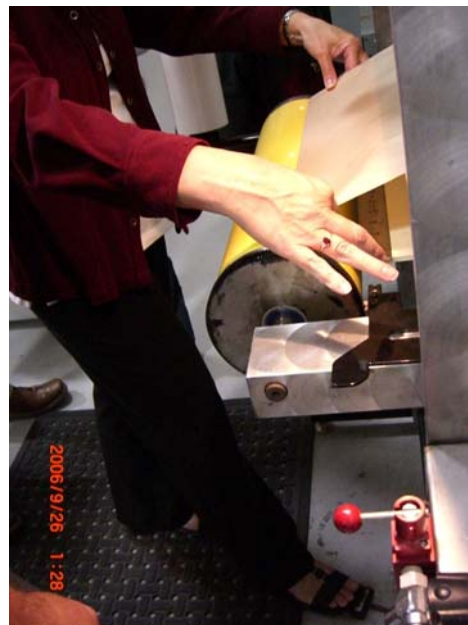
(透過儀器輔助，將凸版版模置放於 Plate Cylinder)
