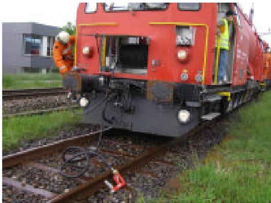
圖 99、車頭前端可一人操做消防水帶
