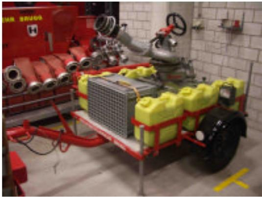
圖 75、移動式砲塔拖車
