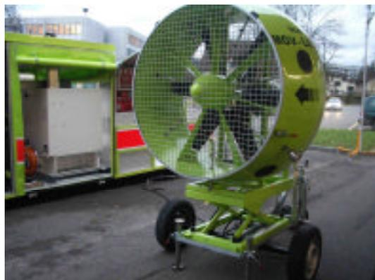
圖 90、供隧道救災使用移動式排煙機
