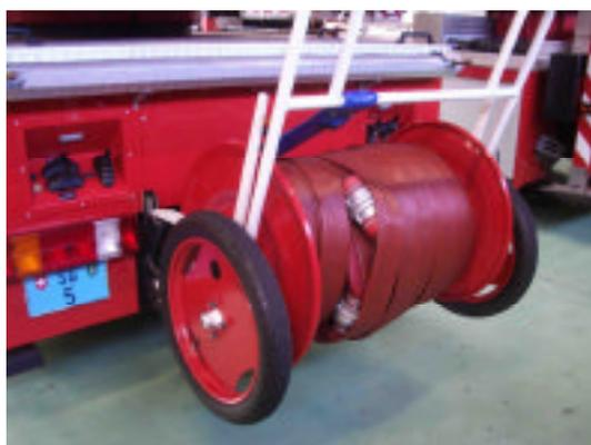
圖 67、置於消防車後的水帶鋪設器
