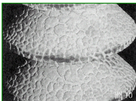
圖 10、11： EPDM 套管經紫外線照射所產生的裂紋及白色粉狀物
