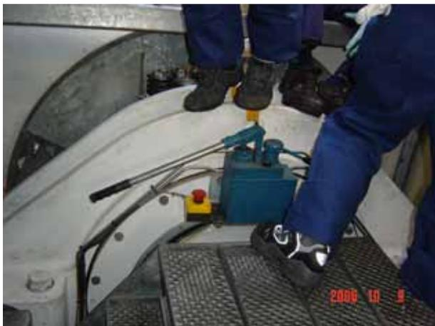
手動煞車閉鎖裝置
