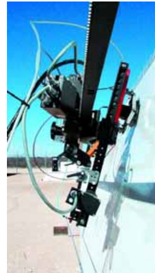
圖12：現場偵測葉片結構之二
