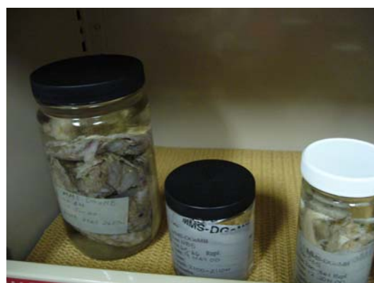
裝標本的容器，瓶蓋有塞子或有鐵弗龍等設計， 可以減少浸泡溶液的蒸發及侵蝕
