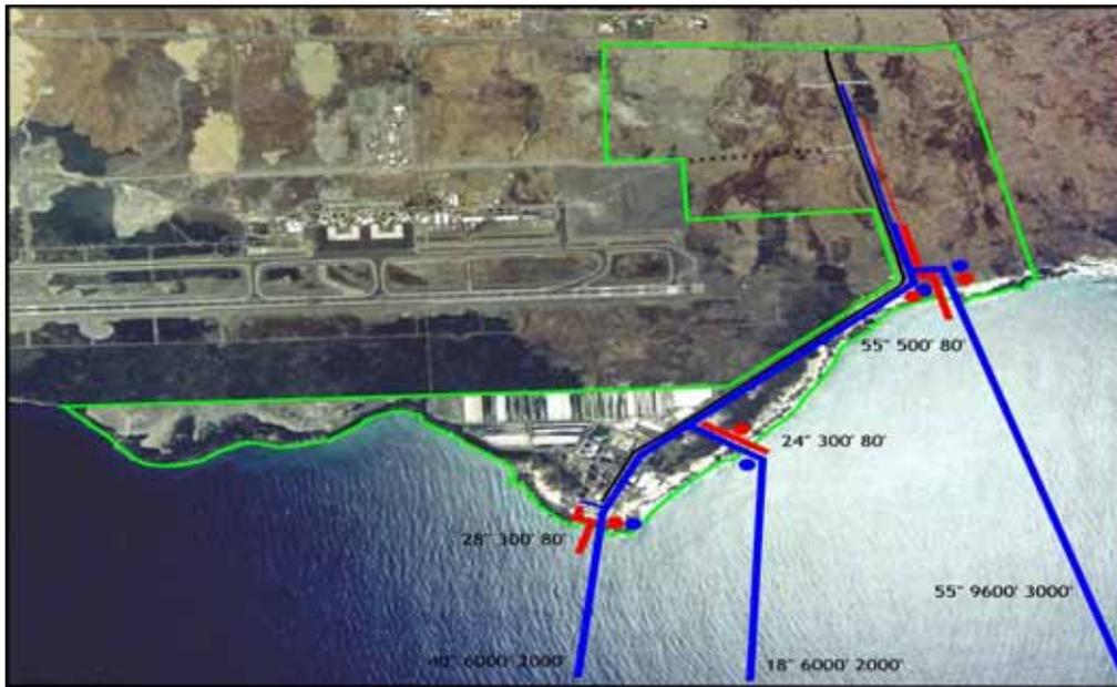
圖 4、NELHA 取水管配置圖
