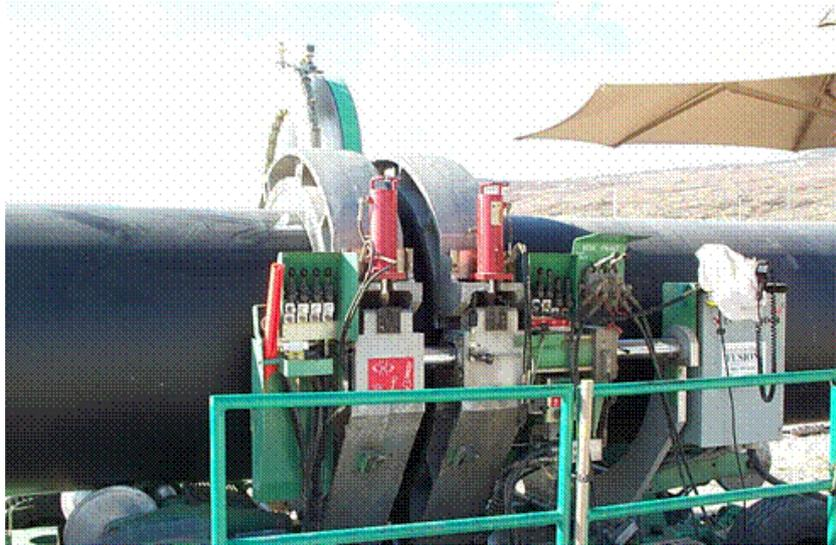
圖 7、NELHA 取水管熱熔接合設備
