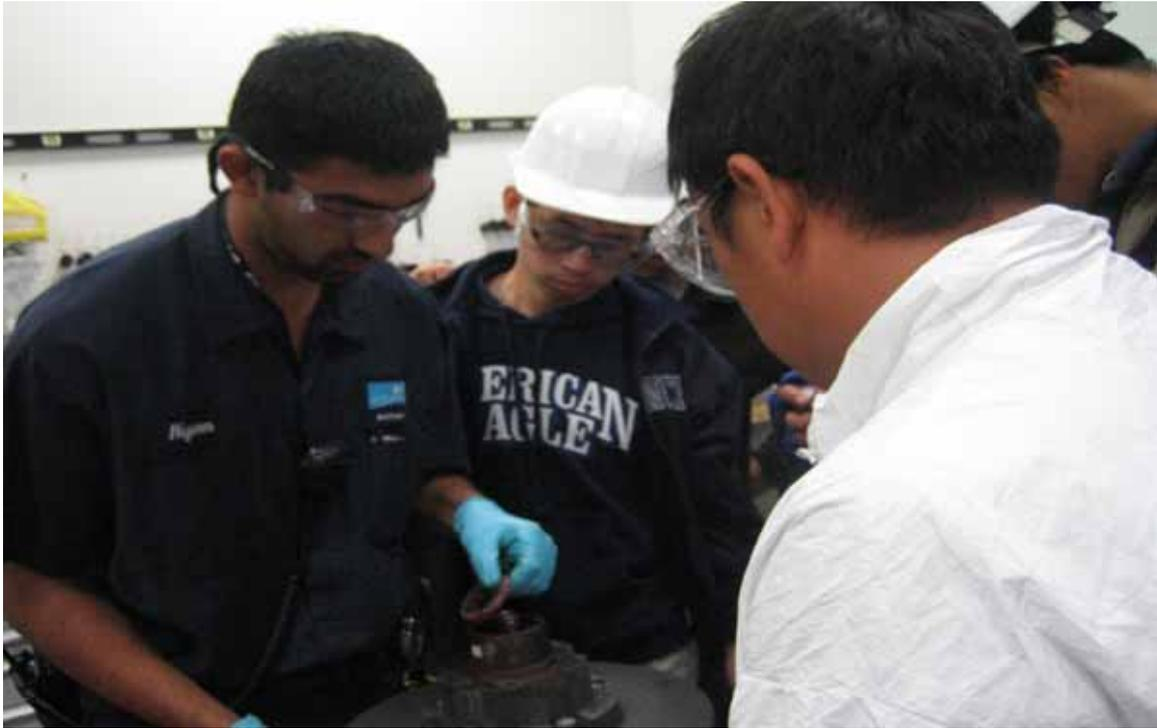
圖 3.3-9 舊金山 AIRTRAIN 電聯車維修人員行走輪零組件更換作業
