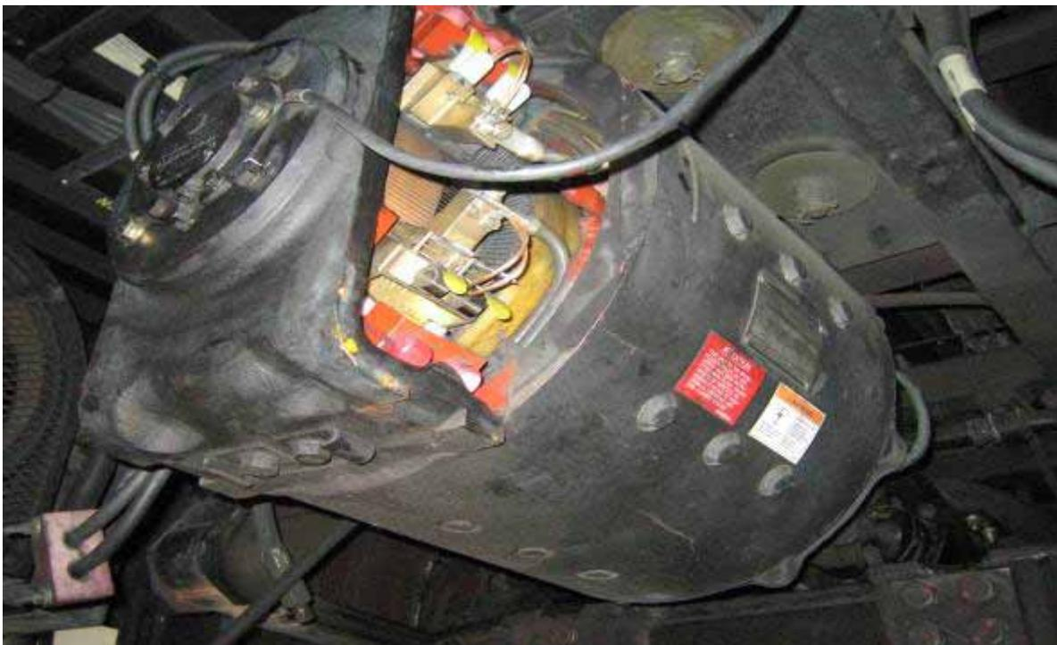
圖 3.3-28 舊金山 AIRTRAIN 電聯車推進馬達
