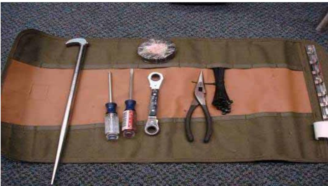
圖 4.2-2 緊急搶修工具包內工具
