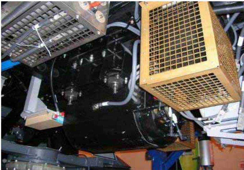
圖 2.4-122 煞車與過電壓保護設備
