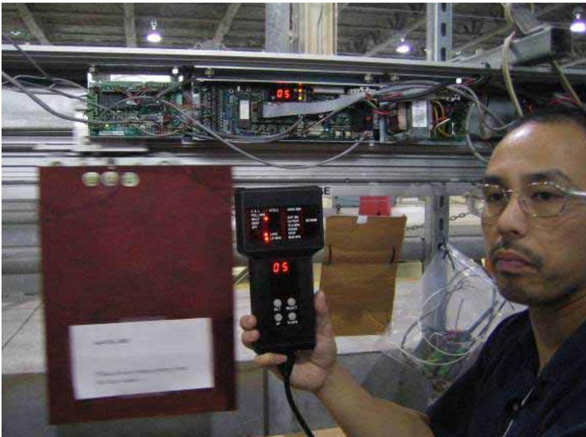
圖 3.2-6 舊金山 AIRTRAIN 月台門維修延伸微處理器
