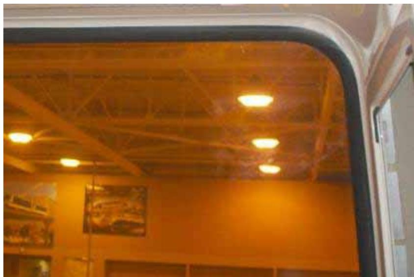
圖 2.4-30 車端擋風玻璃與收邊修飾橡膠膠條
