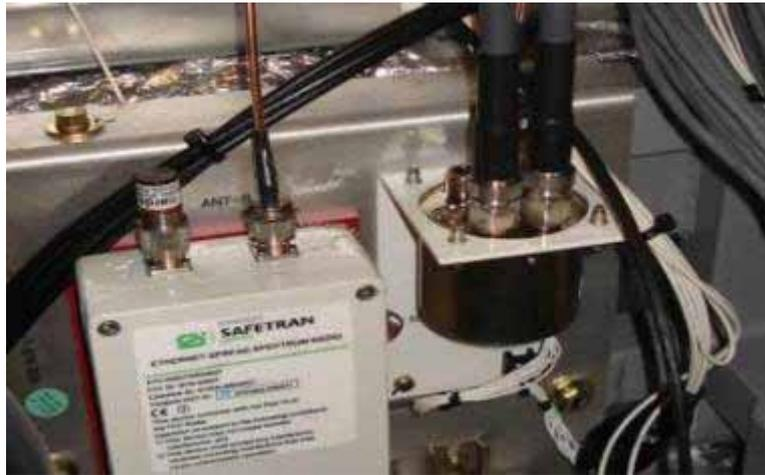
圖 2.3-42 四路射頻(RF)無線電訊號切換總成 (4Way Switch)
