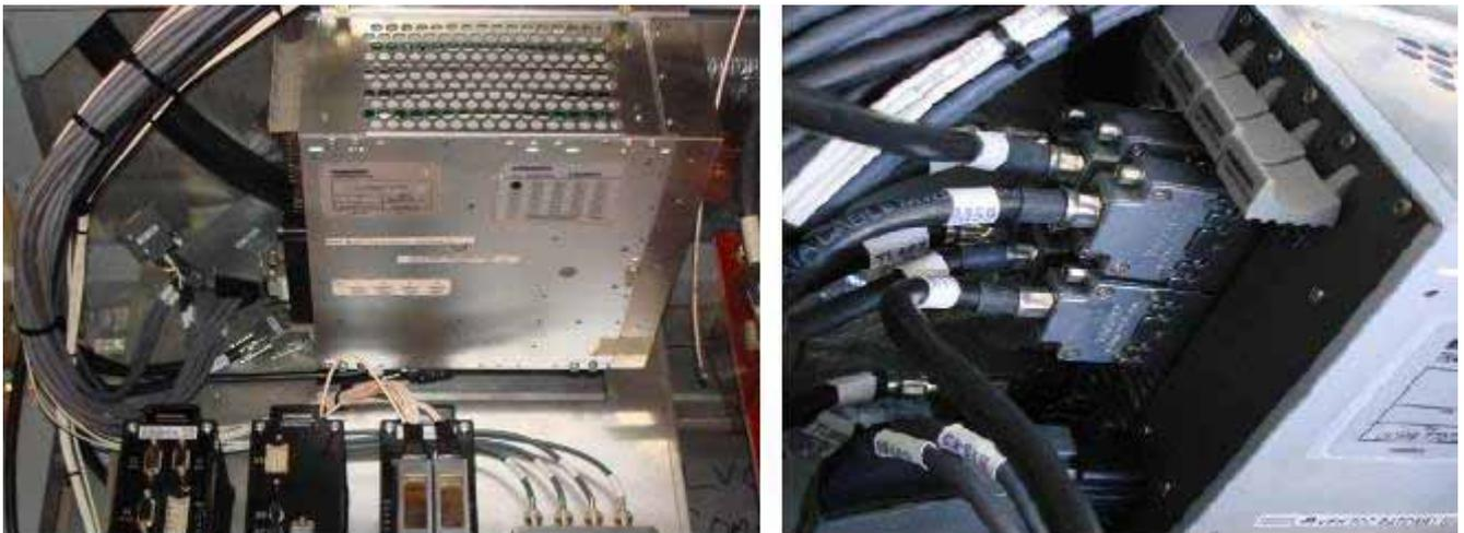
圖 2.4-72 在 7 號設備隔箱內 Gateway 總成與 VCU 控制板之相關位置
