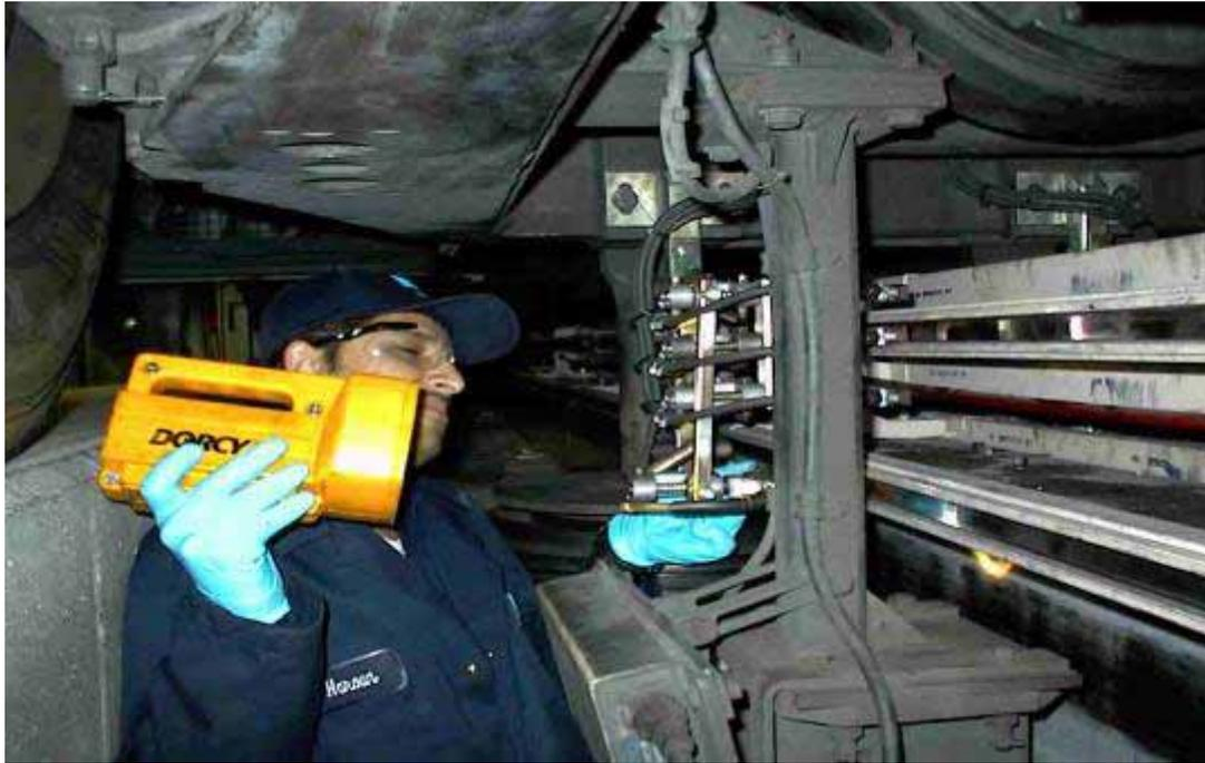
圖 3.3-5 舊金山 AIRTRAIN 電聯車集電靴檢修作業
