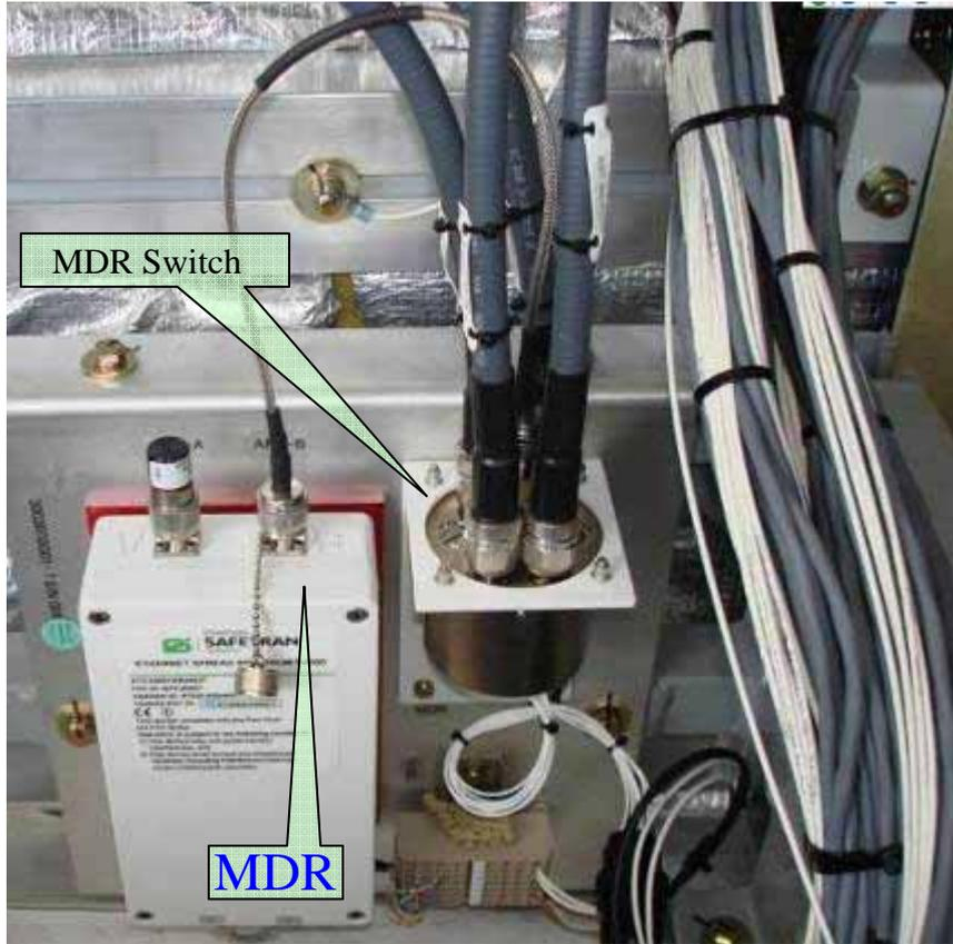
圖 2.4-131 Mobile Data Radio (MDR)移動數據無線電及 4 路開關組
