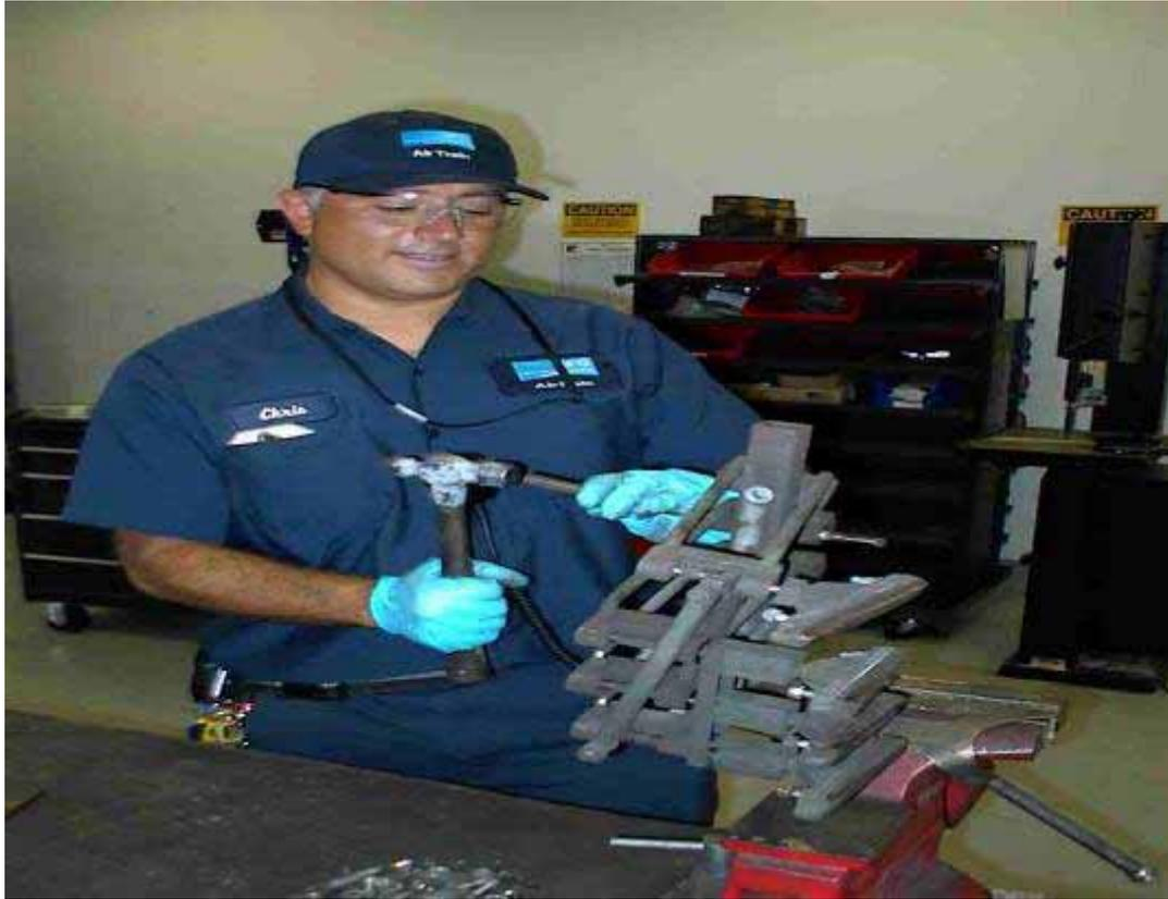
圖 3.3-7 舊金山 AIRTRAIN 電聯車集電靴檢修作業
