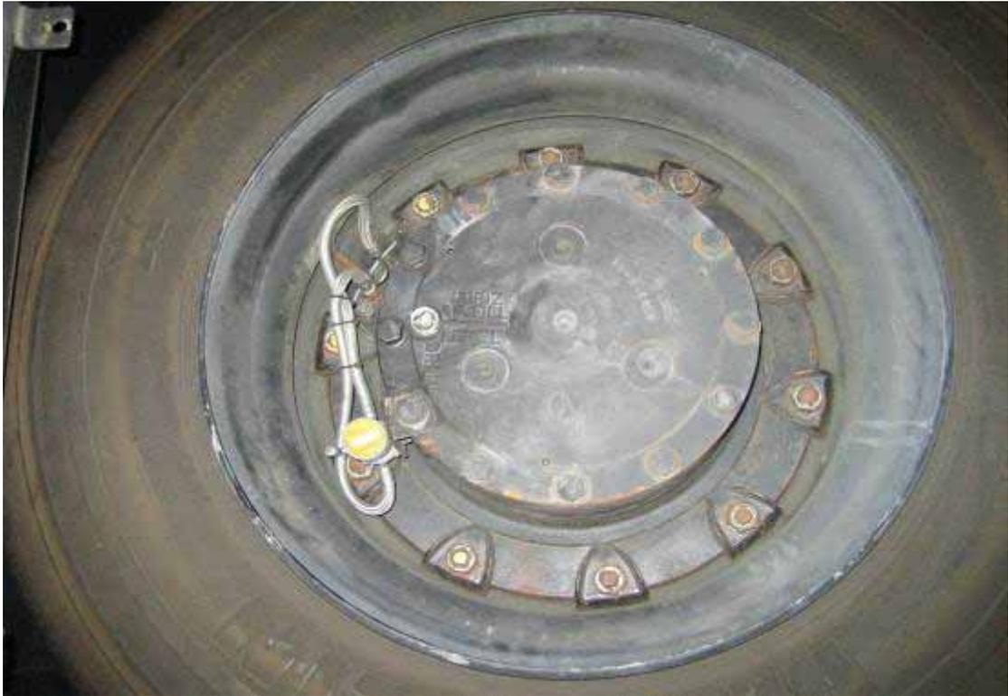
圖 3.3-31 舊金山 AIRTRAIN 電聯車行走輪胎壓偵測器
