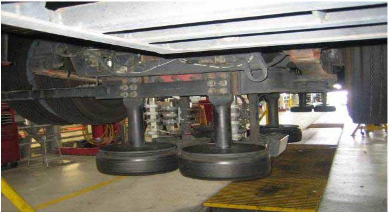
圖 3.3-30 舊金山 AIRTRAIN 電聯車導引輪
