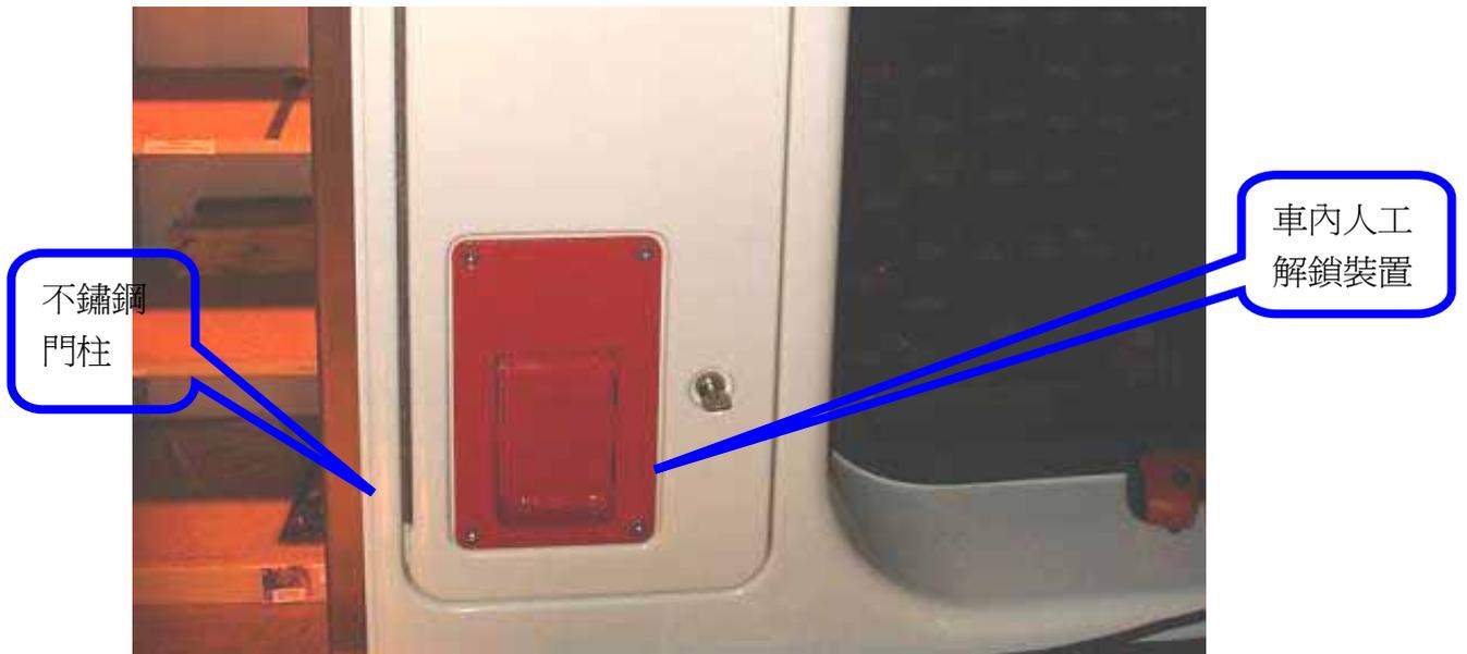
圖 2.4-25 不鏽鋼門柱與車內人工解鎖裝置
