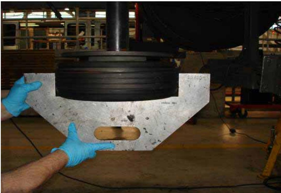
圖 3.3-8 舊金山 AIRTRAIN 電聯車導引輪檢修作業
