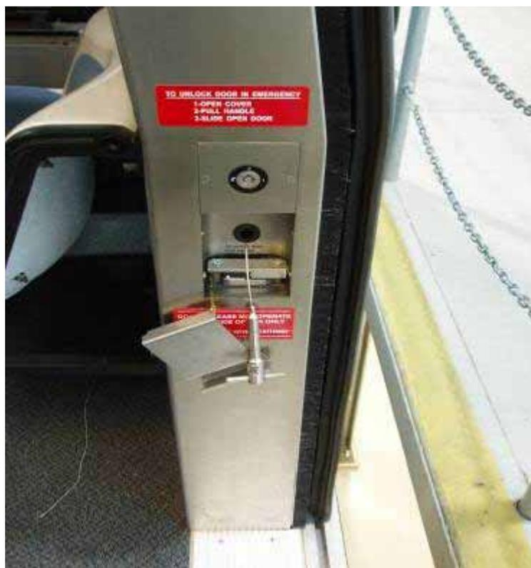
圖 3.3-26 舊金山 AIRTRAIN 列車緊急手動開啓車門裝置
