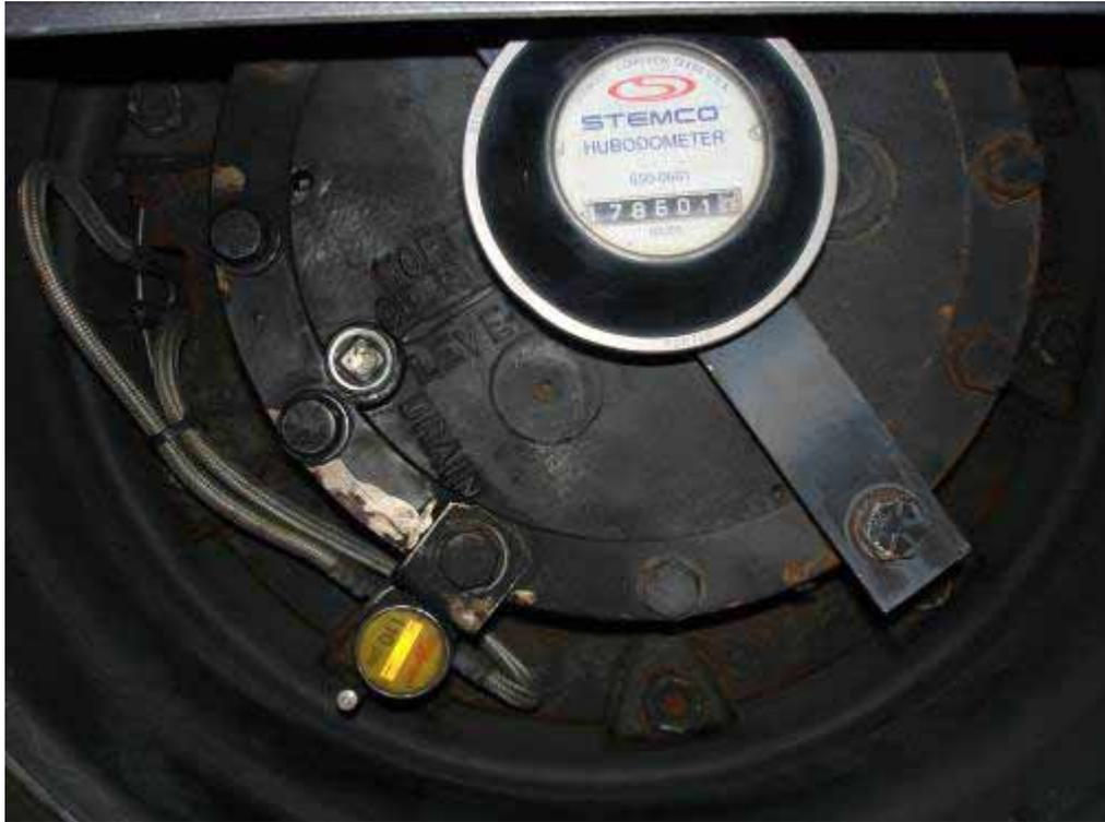
圖 3.3-33 舊金山 AIRTRAIN 電聯車行走輪之胎壓偵測器及里程表
