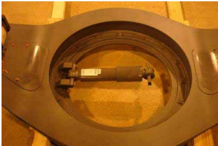
圖 2.4-65 橫向減震筒及橫向橡膠止擋
