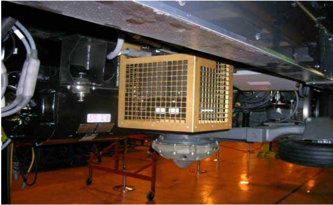
圖 2.4-102 直流線路電抗器
