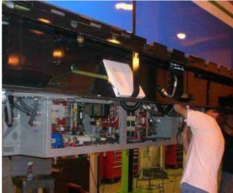
圖 2.4-119 車底 PLT 機箱內的推進換流器
