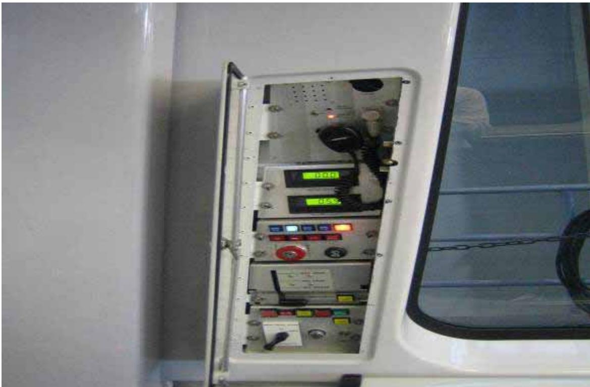
圖 3.3-24 舊金山 AIRTRAIN 列車手動駛控制台
