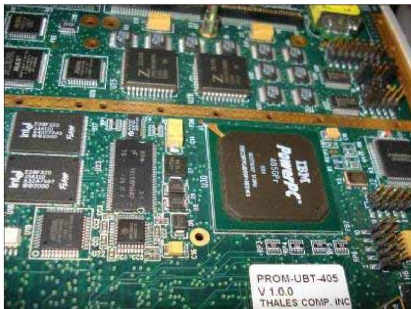
圖 2.4-140 ATP CPU BOARD –POWER PC 400Mhz 微處理器
