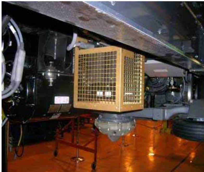
圖 2.4-120 機箱外的直流線路電抗器
