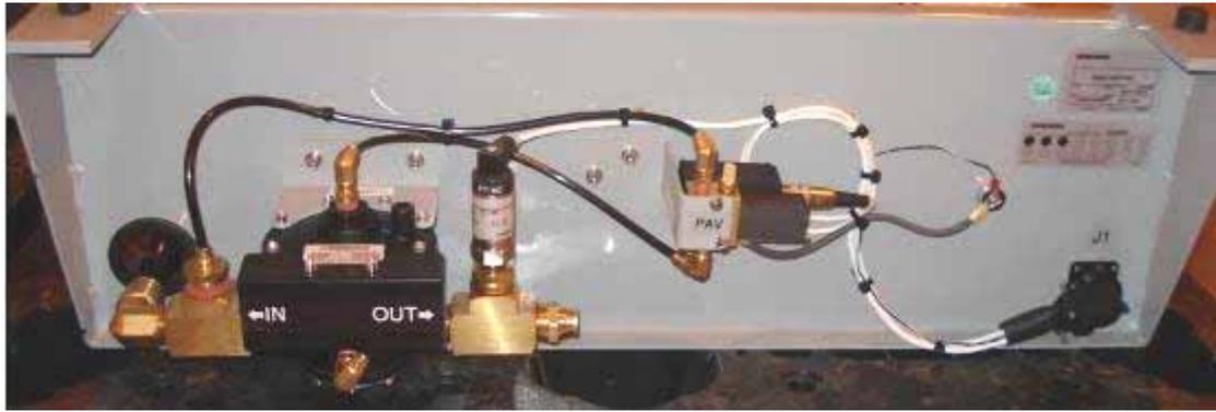
圖 2.4-60 煞車氣壓控制盤外側
