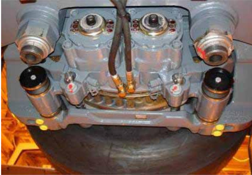
圖 2.4-56 摩擦煞車設備（煞車卡鉗）
