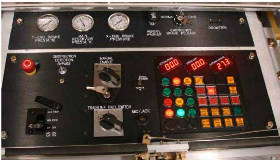
圖 2.4-14 車端內飾板下裝載設備
