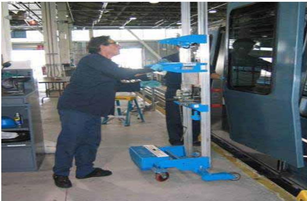
圖 3.3-6 舊金山 AIRTRAIN 電聯車車門檢修作業
