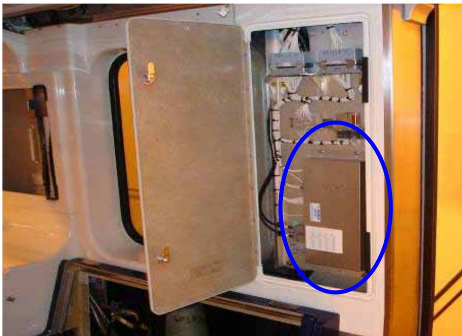
圖 2.4-93 車門控制盤 DCP
