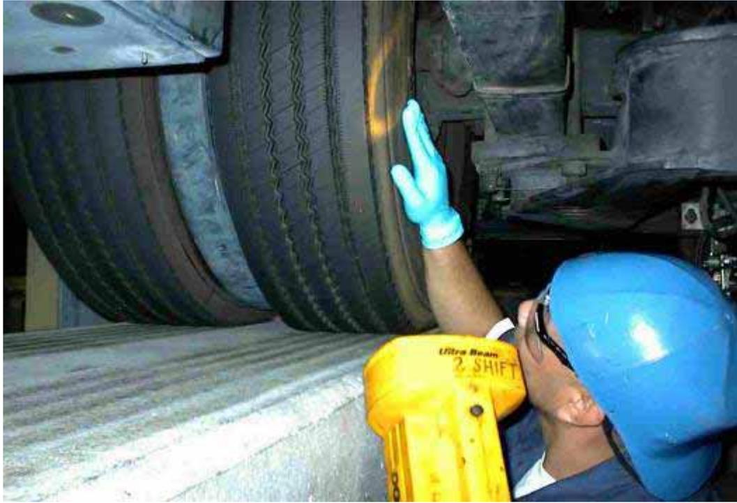
圖 3.3-3 舊金山 AIRTRAIN 電聯車行走輪檢修作業
