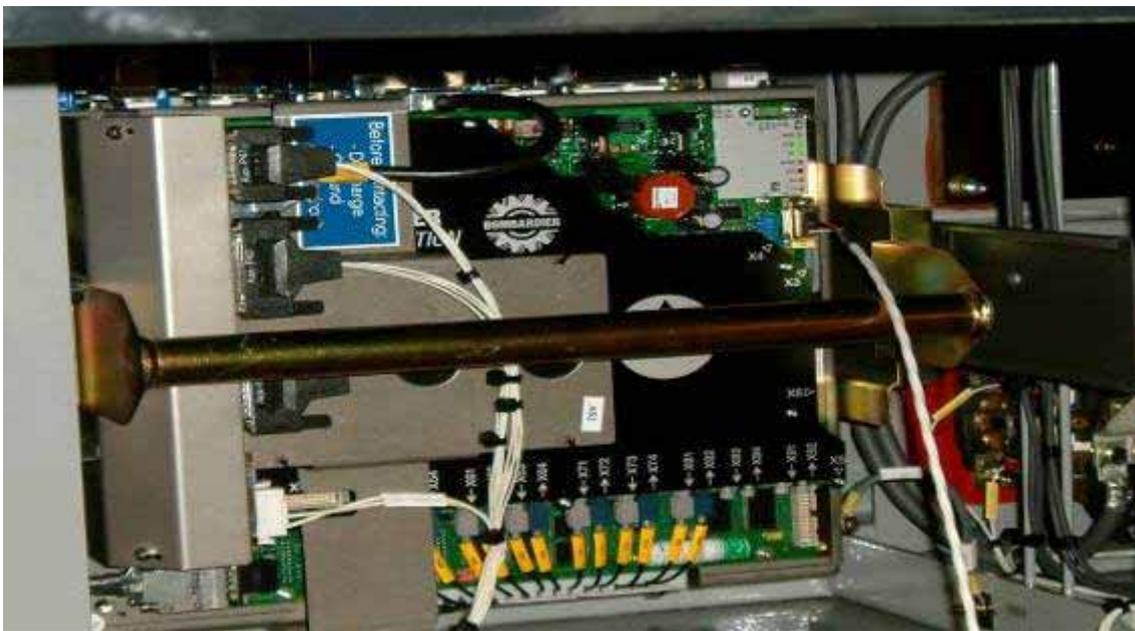
圖 2.4-123 MITRAC 模組上 PTU 設備連接埠
