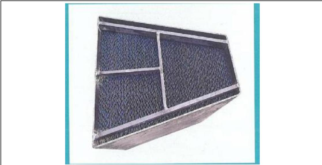
圖四、將傳熱材堆壘擺入成扇狀的藍子內，形成蜂巢狀
