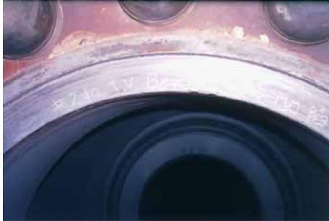
圖三十一、閥蓋與閥體密封墊嵌合處損傷情形。
