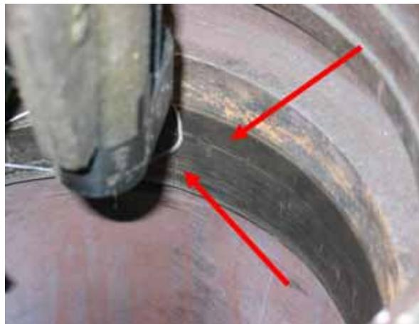
圖三十、閥體內部壓力封環吹蝕損傷情形。
