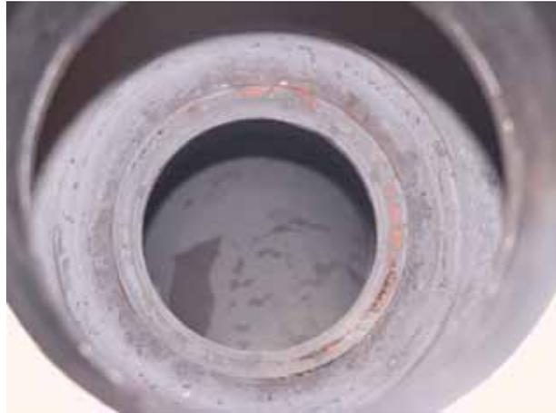
圖二十九、控制閥閥座摩擦損傷情形。
