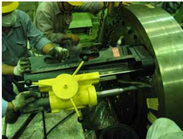
圖二十六、汽機聯軸器螺栓卡死處理情形。
