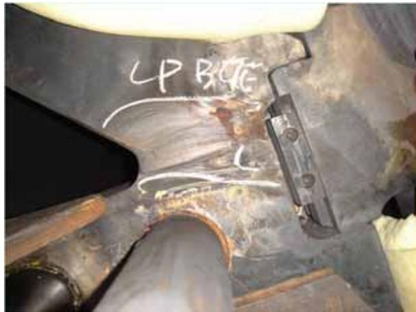
圖二十四、汽機內缸水平接合面吹蝕情形。
