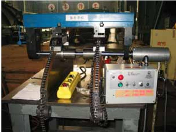
圖二十七、聯軸器螺栓螺孔車修機。
