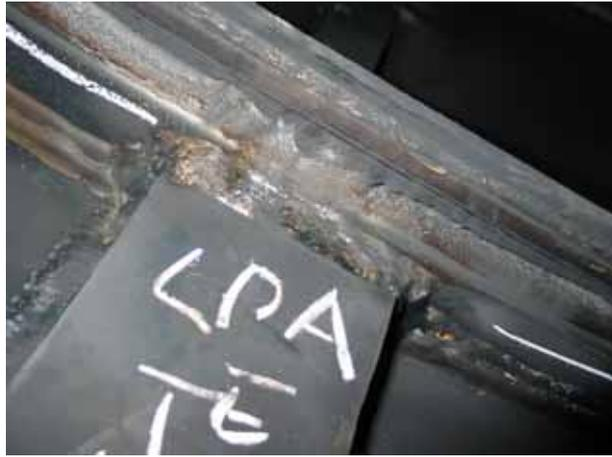
圖二十五、汽機靜葉環蒸汽止漏面吹蝕情形。
