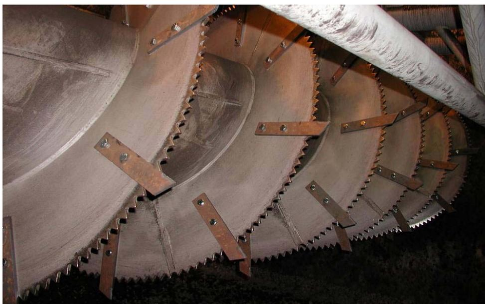
圖 7、切割刀片（Cutting Bar）
