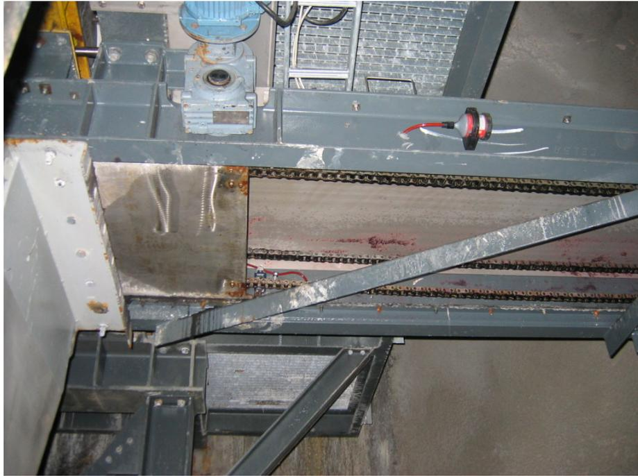
圖 15、煤倉底部出煤口之活動式擋板
