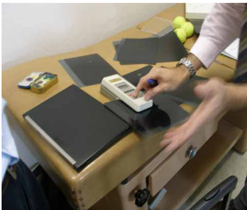
圖 17 底片光密度值之測量
