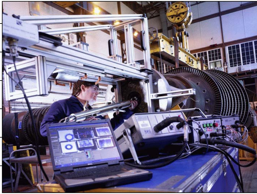
圖 22：左圖為 steam turbine 高階超音波檢測。
