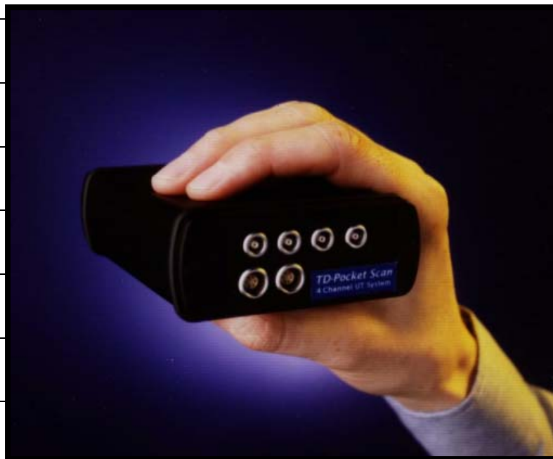
圖 4：TD POCKET SCAN 是 Phoenix 公司最新發展的 的 TOFD 檢測儀器
