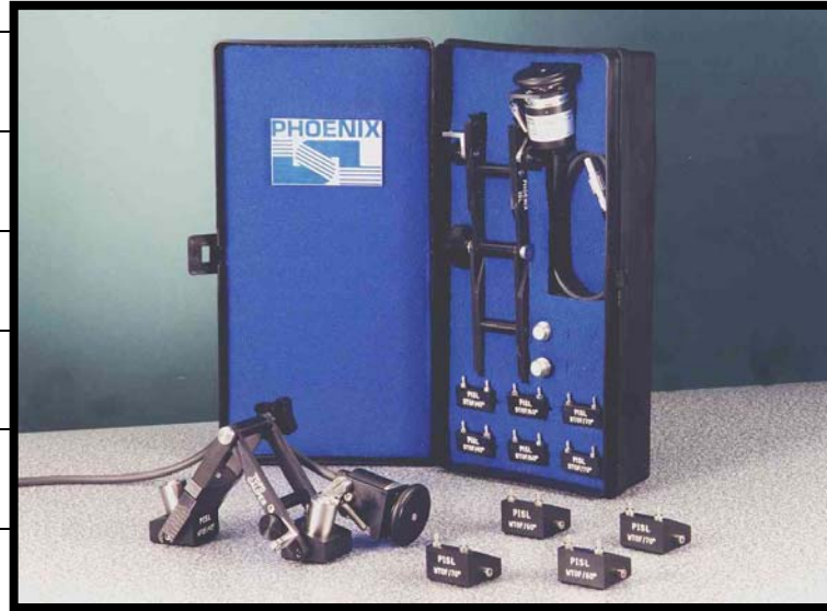
圖 5：TOFD 檢測角規及探頭，簡易輕巧之配備可提供 TOFD 快速手動掃瞄及檢測結果記錄。
