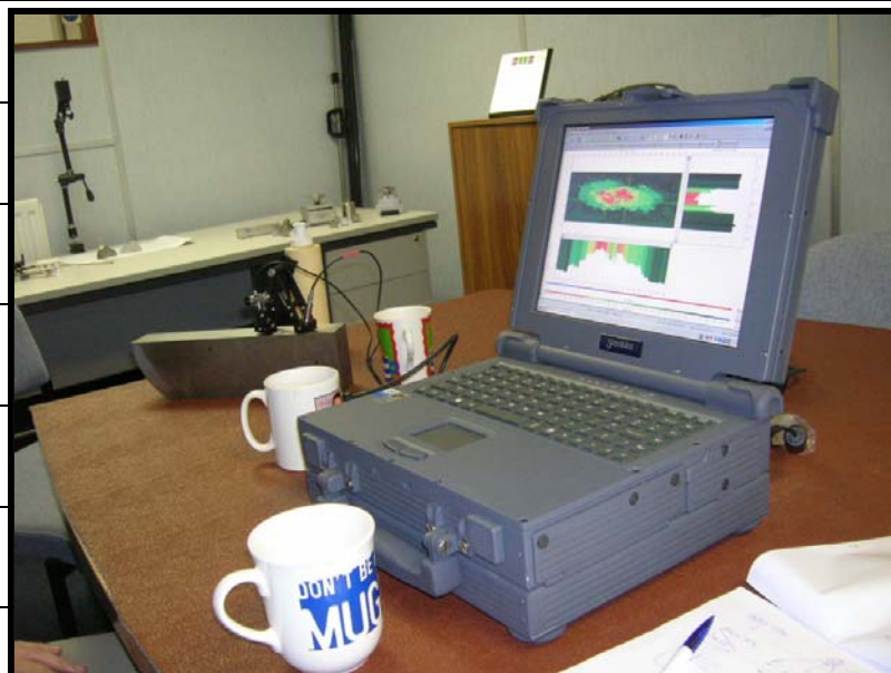
圖 12：db-ut 檢測系統銀幕所示則為 corrosion mapping 分析結果
