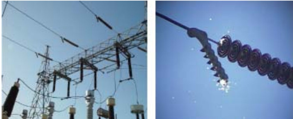
圖 6 紫外線電暈影像儀檢測電暈放電
