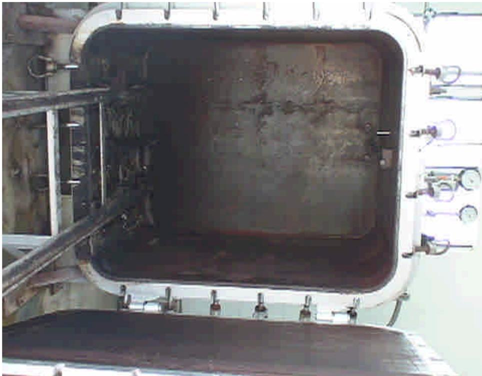
(圖四) 蒸汽式蒸煮室。
