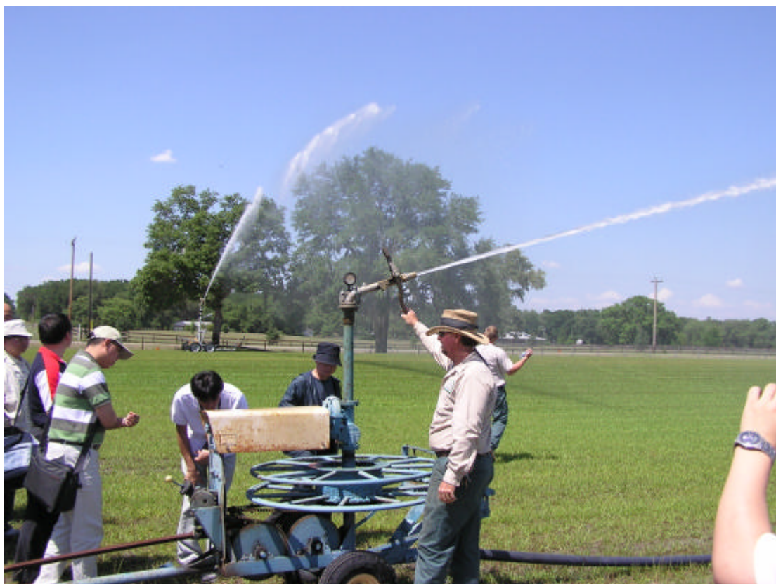
圖3-8 噴灌之供水設備
