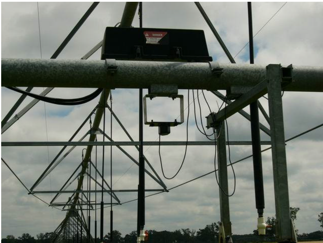
圖3-13 Liner Pivot移動控制天線
