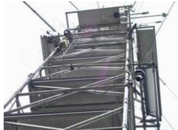
高塔吊掛著不同用途感應器；右圖於 1995 年所增建的 12 公尺高塔，其上儀器用來觀測樹冠層以上二氧化碳流動。
