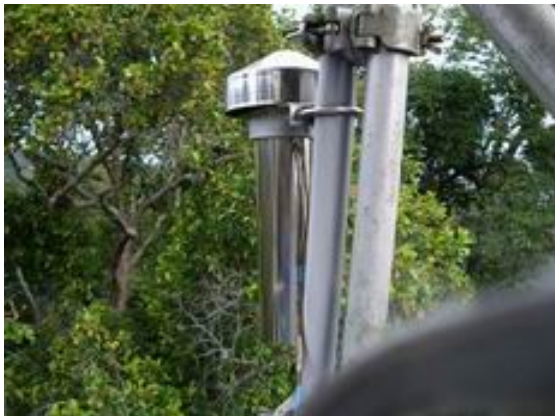
高塔吊掛著不同用途感應器；右圖於 1995 年所增建的 12 公尺高塔，其上儀器用來觀測樹冠層以上二氧化碳流動。
