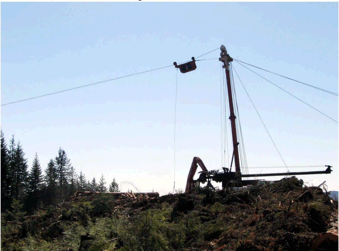
圖 2、2006 年 05 月 18 日參觀 Longview Fibre 公司採用索道運材方式進行伐木作業
