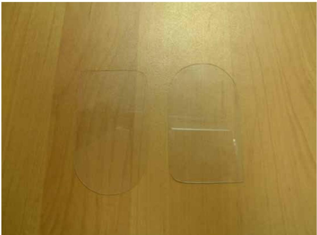
圖十五 俄國使用固態雷射切割後的玻璃試片一(可切圓弧及直角)
