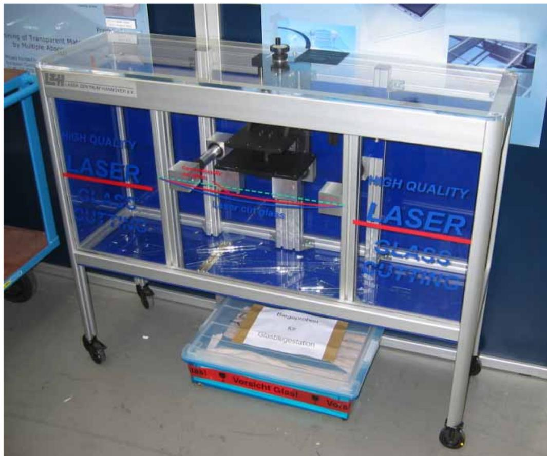
圖八 原廠使用之玻璃 Bending moment 試驗機
