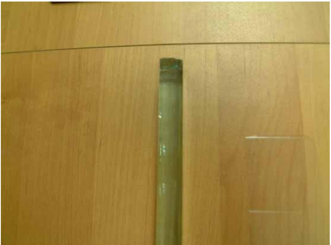
圖十七 俄國使用固態雷射切割後的玻璃試片三(可切厚玻璃，照片所見厚度為1公分)
