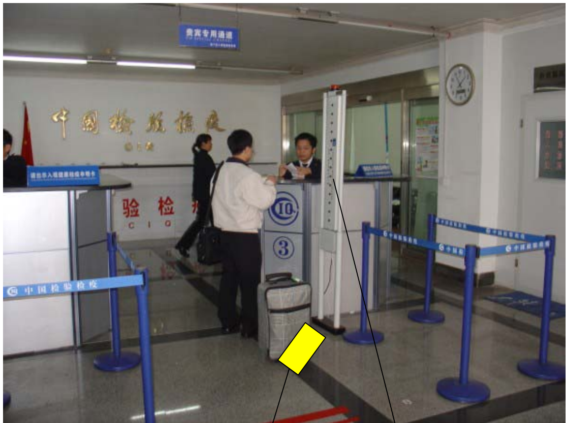
附圖二 入境檢驗檢疫櫃檯繳交健康檢疫申明卡，同時以多點式紅外線體溫測量儀量測體溫（人員需立定，以眼睛注視與眼睛平高之測量點）。
