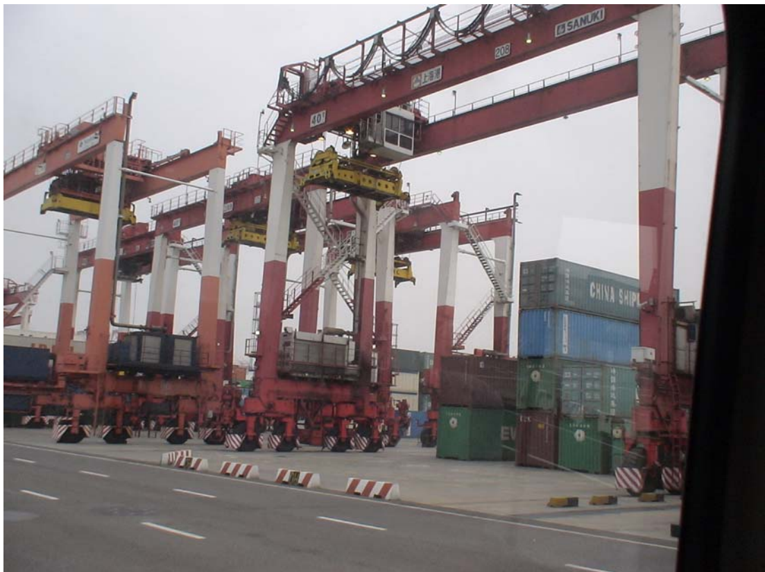
圖 18 上海港集集裝箱公司貨櫃碼頭後線利用 5+1 排輪胎式門式起重機佈置
