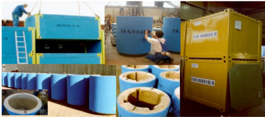
圖十 回收金屬所製作各型屏蔽貯存容器
