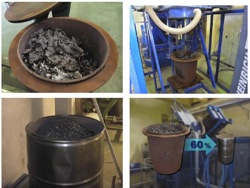
圖八 爐渣再減容作業
