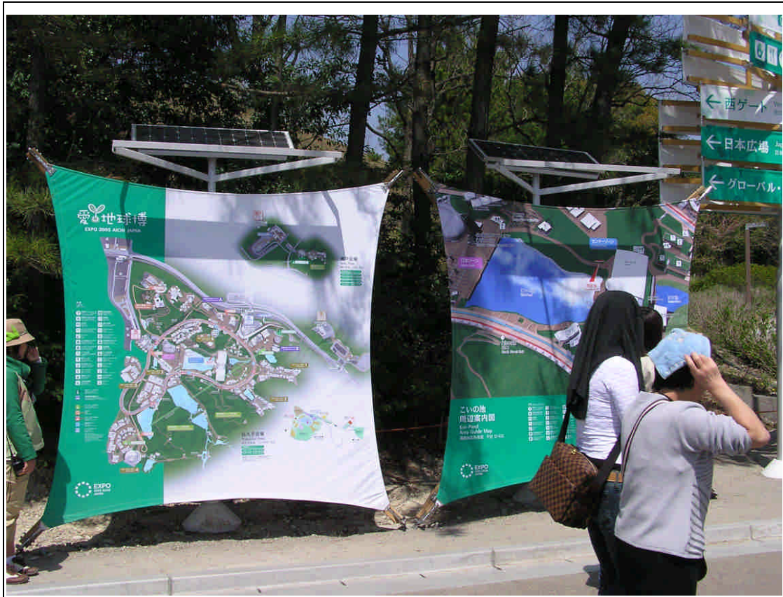
路旁利用太陽能光電板做為夜間照明的地圖解說牌
