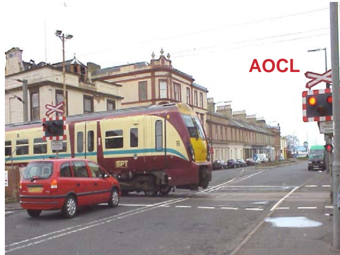
照片六 自動開放式就地監控式平交道(AOCL)
