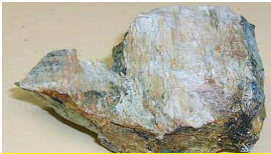
石棉經電漿熔融爐處理後產生之離子化玻璃熔渣
