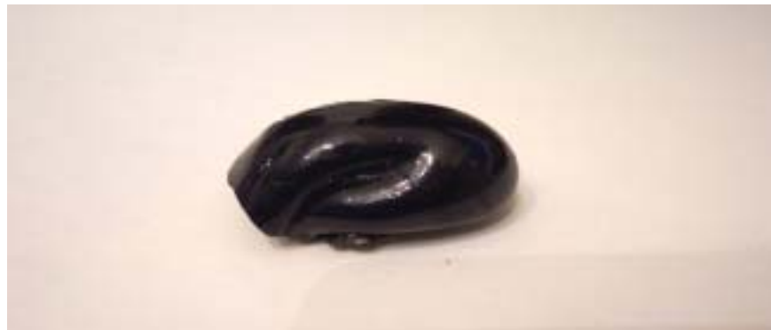
廢輪胎經電漿熔融爐處理後產生之離子化玻璃熔渣
