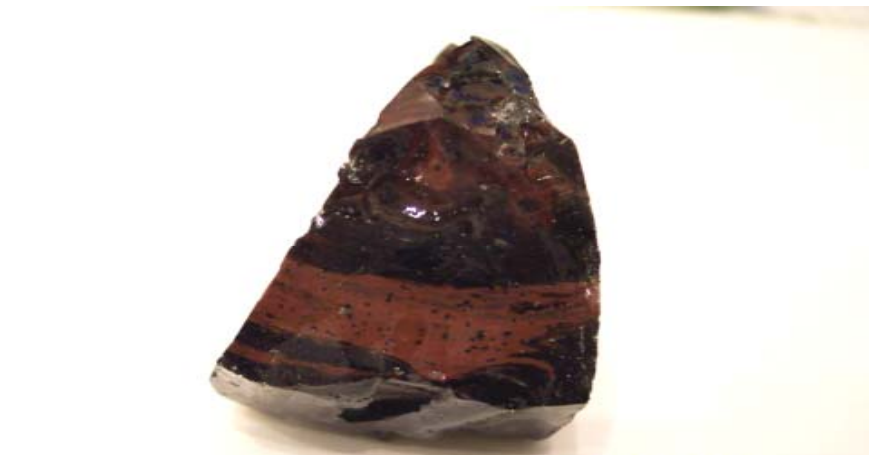
廢印刷電路板經電漿熔融爐處理後產生之玻璃熔渣
