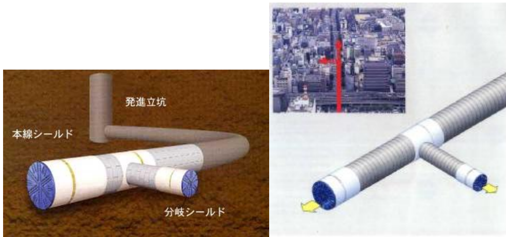
(圖 4-6，T 分歧潛盾示意圖，關西電力)
