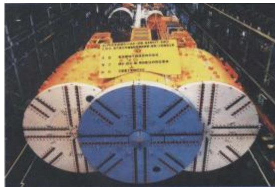
(圖 5-5, 連圓形斷面潛盾機外觀, 三菱重工)
