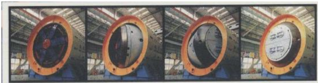
（圖 4-2，球體迴轉式更換切刃齒，三菱重工）
