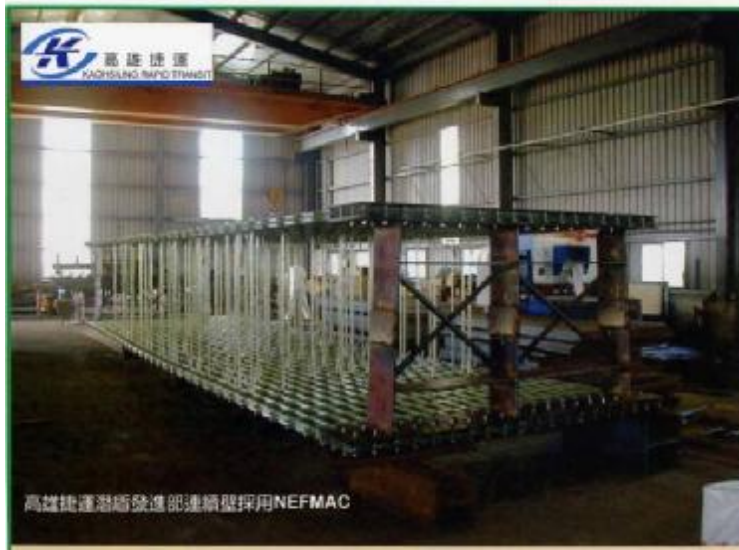
(圖 3-5，NEFMAC 工廠組立圖，地工技術,2005)
