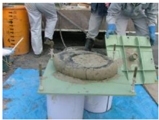
左上：水泥砂漿與摻劑混合之黏稠混合體
