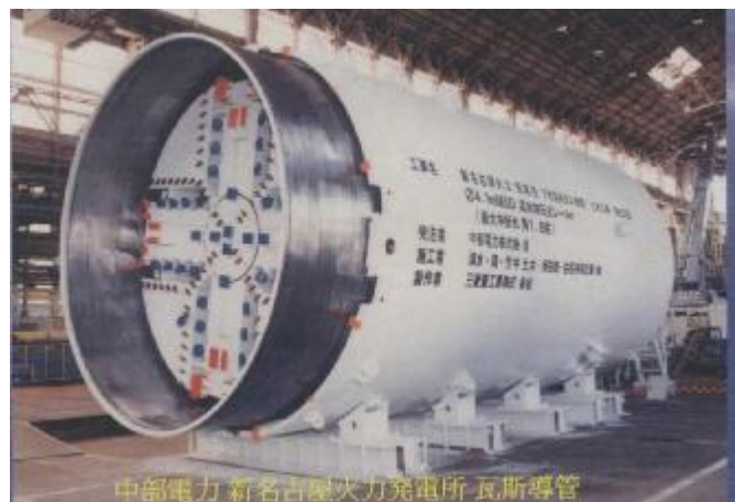
(圖 4-4，地中接合用潛盾機，三菱重工)
