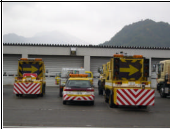
圖 4-5-20 養護車輛裝設箭頭警示標誌
