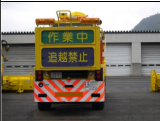
圖 4-5-19 養護車輛裝設文字警示標誌
