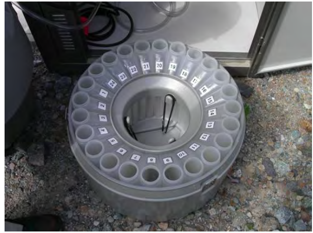
照片 004 美和水庫 bypass 排砂隧道出口懸 浮載水樣取樣設備(1/3)
