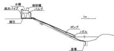
図-5 付着藻類剥離実験装置配置
