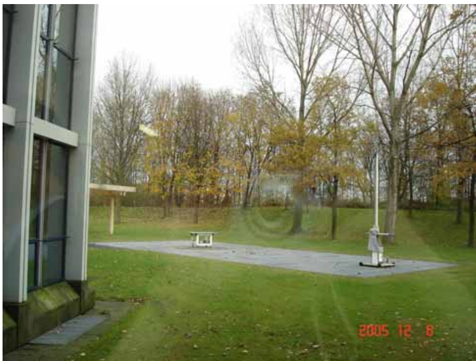
德國萊因(TÜV Rheinland)EMC 試驗室之 10 米 Open Site
