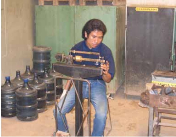
▲9月15日參觀雅加達 P.T. Altraman 衡器製造廠—技術人員 正進行台秤調校工作
