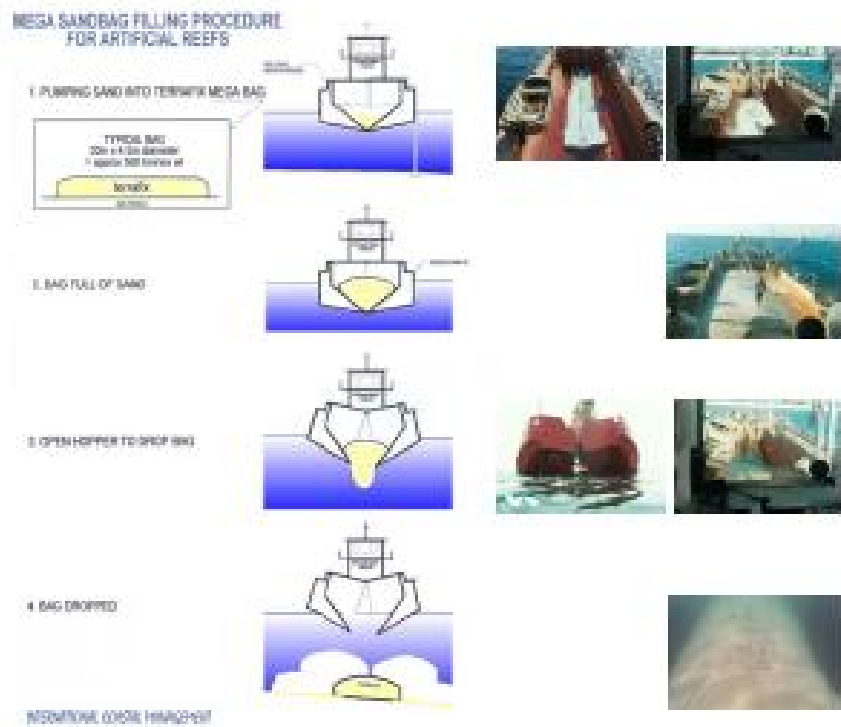
圖 5 巨型砂袋式海底淺堤製作及投放程序
