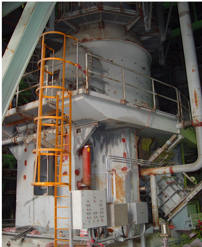
圖 1-2. 台中九、十號機採用 Loesche 廠家製造的粉煤機
