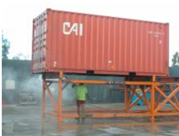
圖 35、附著土壤之貨櫃被運回碼頭清洗區以高壓水柱清洗
