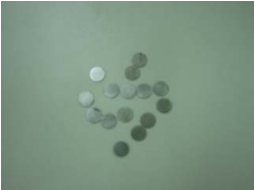
圖 11 加工好的微試件：直徑 8mm、厚度 0.5mm
