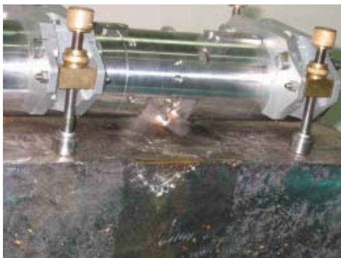
圖 9 取樣器於工件上之取樣情形
