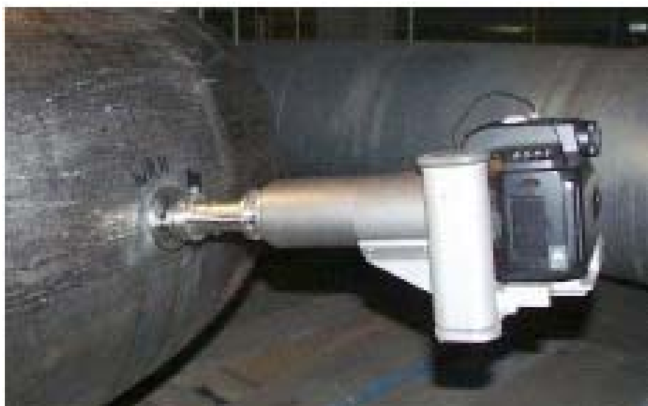
圖 7 現場 SPICA 量測：相機鏡頭一端插入固定夾具進行 image 拍攝
