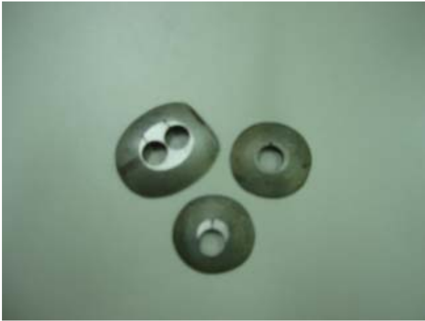
圖 10 取出之試件以線切割方式再加工成試驗用之微試件
