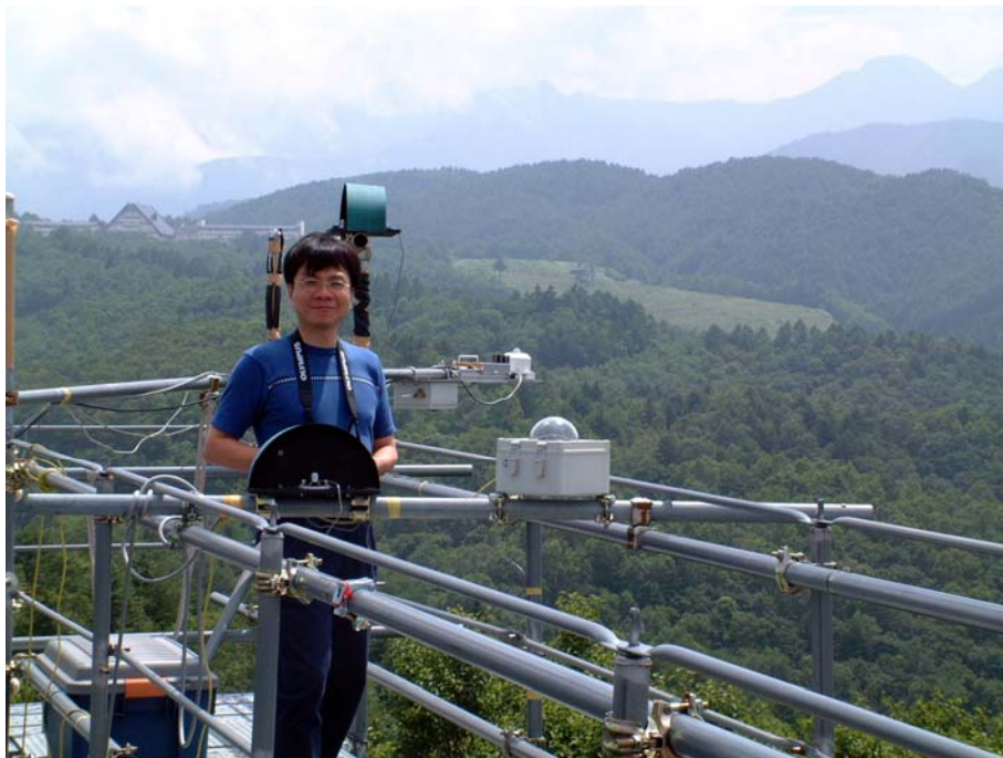
圖 6 高山野外植物生態觀測站支架頂部裝設有測量光譜值之儀器及可向上與向下翻轉之照相設備。
