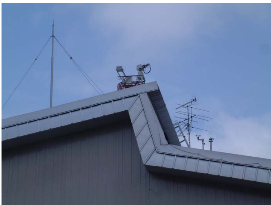
圖 4 岐阜大學流域盆地科學研究中心管理的高山實驗中心，屋頂上所裝設之接收各個方向太陽光資訊的設備，及向上拍攝雲量的相機。
