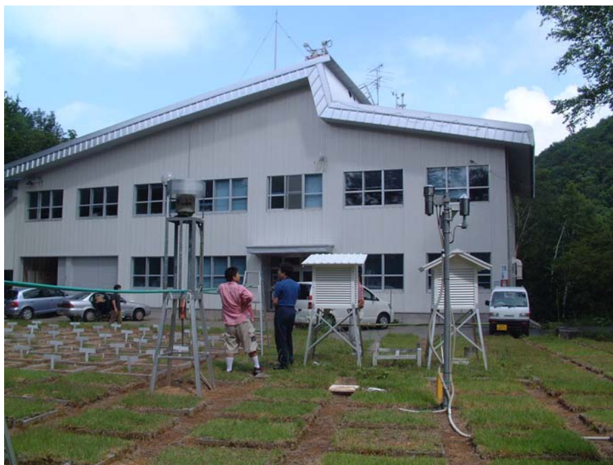
圖 3 屬於岐阜大學流域盆地科學研究中心管理的高山實驗中心，中心旁裝設有監測植物生態變化的設備，屋頂上裝設有接收各個方向太陽光資訊的設備，及向上拍攝雲量的相機。
