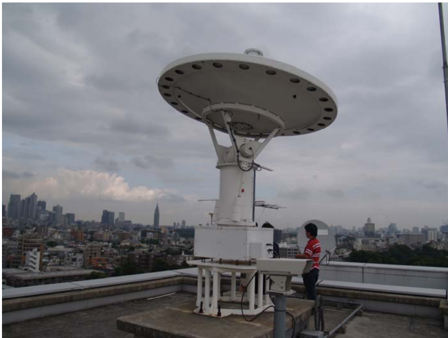
圖 17 位於東京大學生產技術研究所樓頂，接收 MODIS 衛星影像資料的天線。
