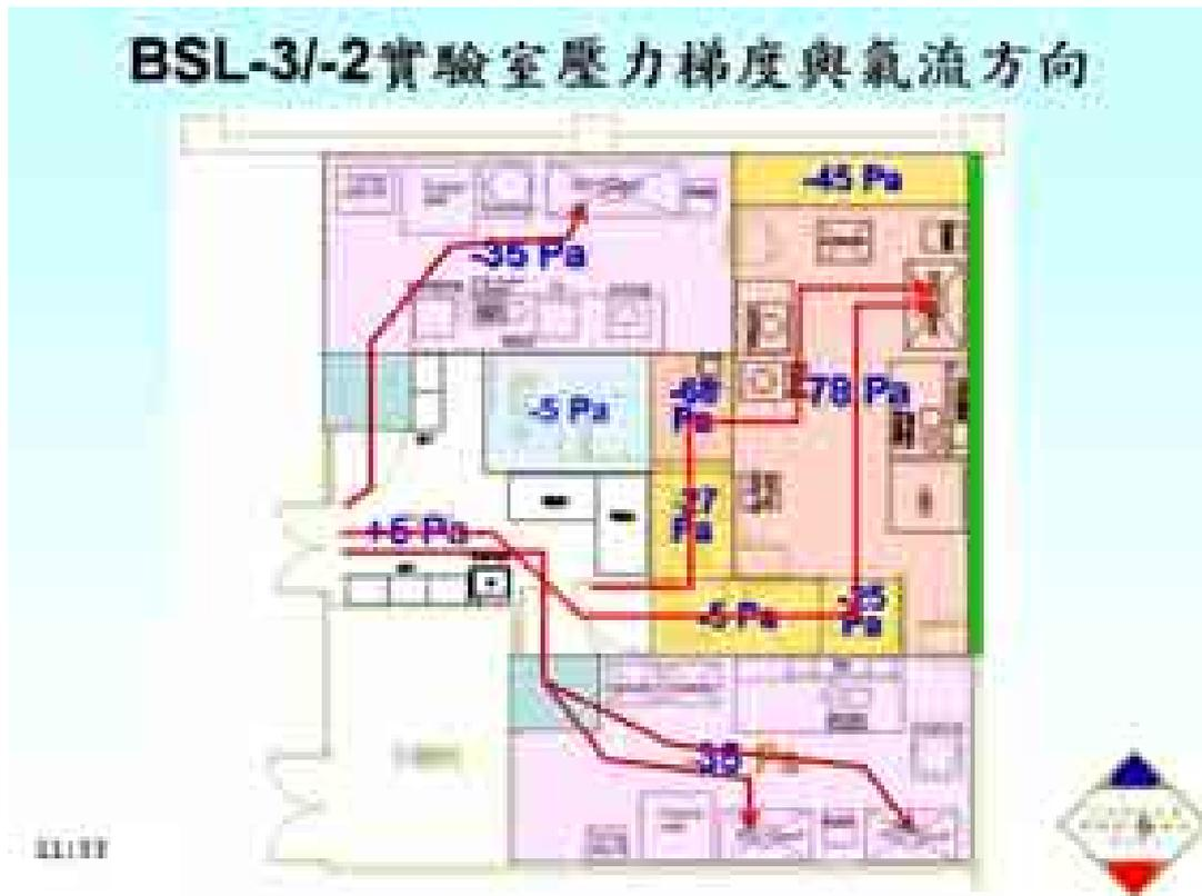
若一旦因任何原因導致實驗室內生物安全操作櫃與空調系統故障，此時實驗室房間、空調風管 (HVAC Duct) 之完整性，以及氣密風管 HEPA 濾網箱 (Airtight HEPA Filter Housing)，將成為防止生物危害性感染物質外散之最後防線。
