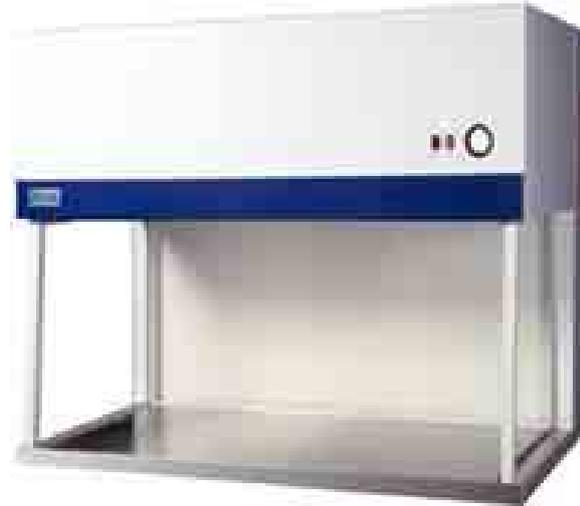
2. Class I 型生物安全操作櫃其排氣通過 HEPA 濾網過濾，且不再操作櫃內循環使用，因此適用於不須保護檢體不受污染的試驗類型。
