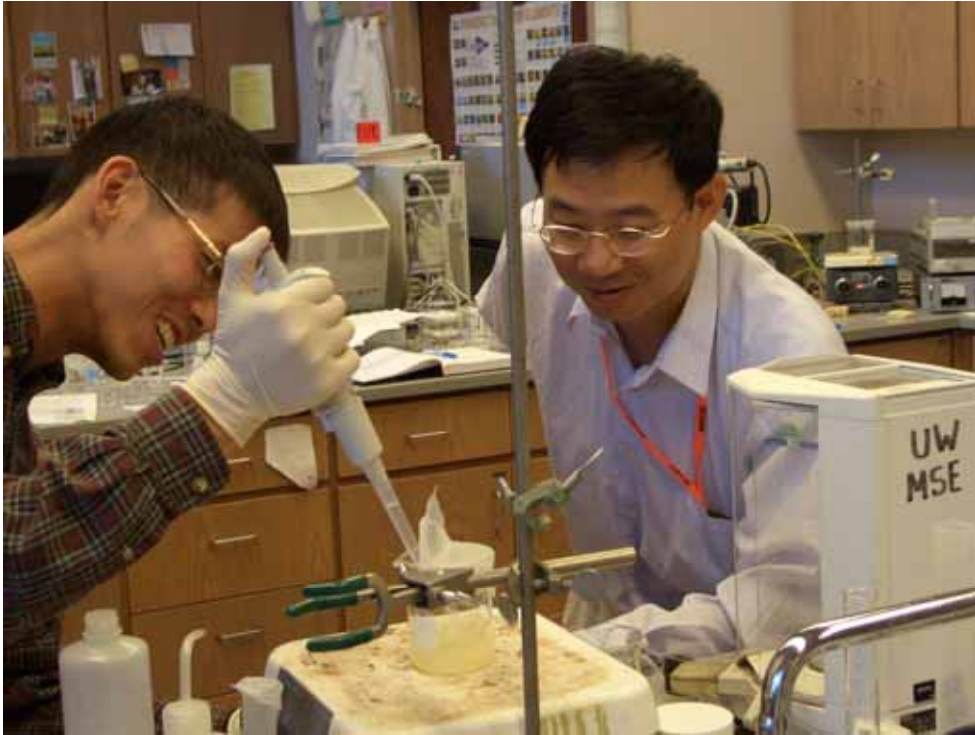
相片十三、與華大機械系博士生 Ryan 在材料科學與工程系實驗室調製鉛鈦酸鉛溶膠
