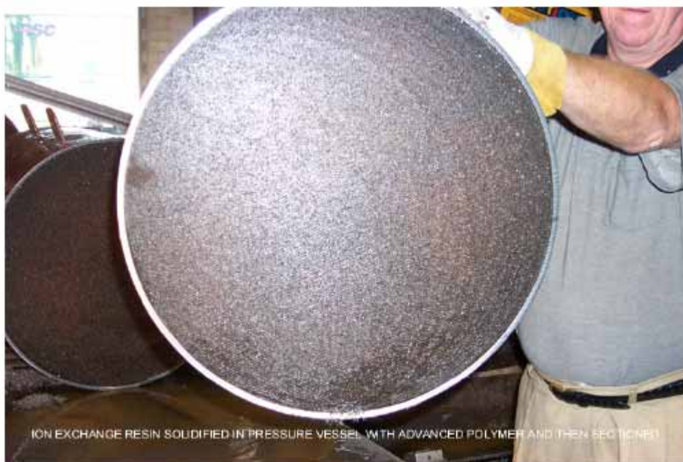
圖五 經APS固化系統製程之用過廢樹脂固化體
