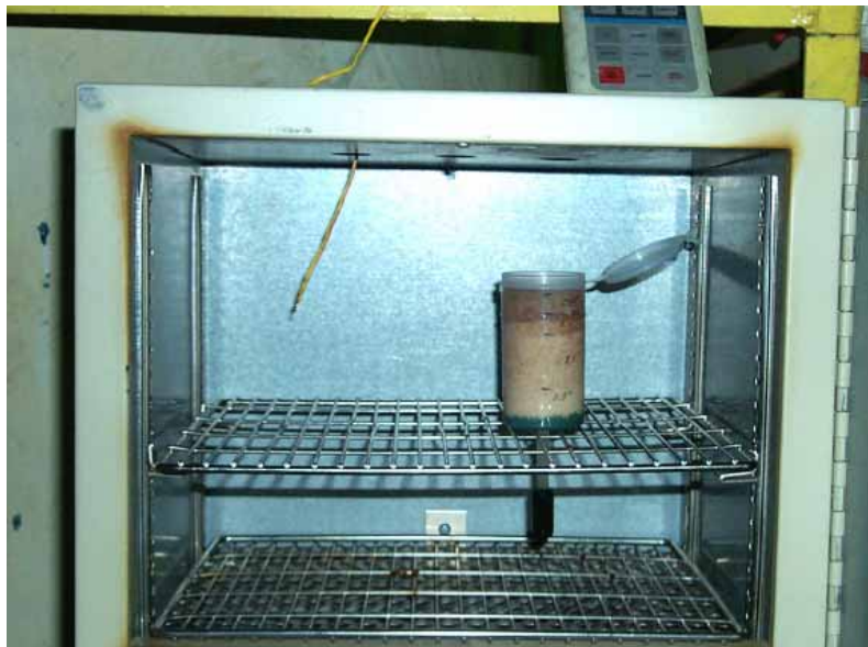
圖三 為加速樣品試驗速率，使用烤箱加熱樣品
