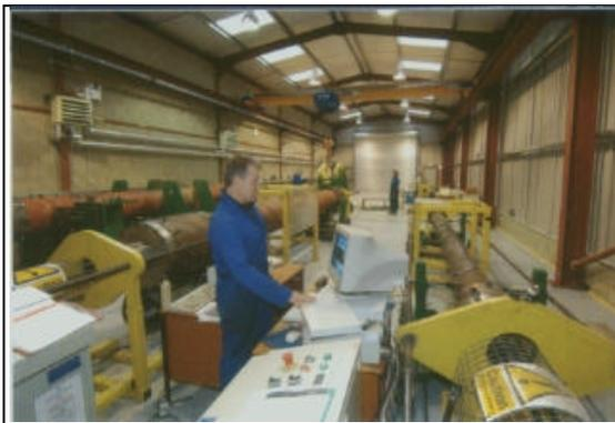
圖十三 管線實體疲勞試驗設備
