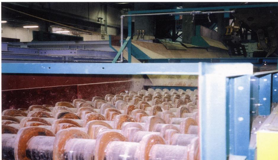
圖8 混合建築廢棄物分類粗選的滾動過塞裝置
