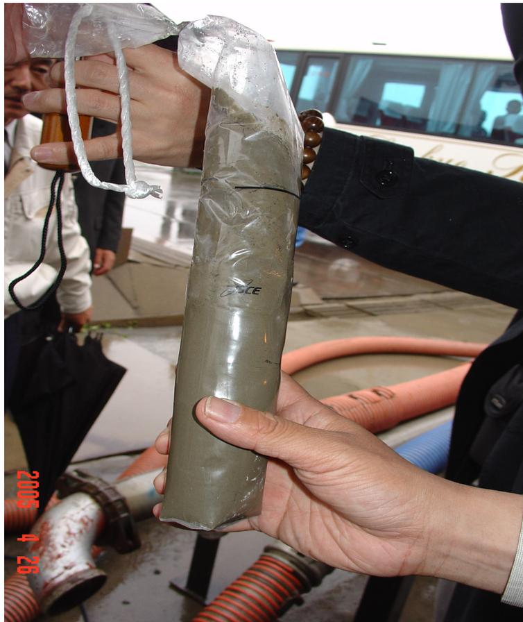
圖18 再資源開發所生產的流動化處理土
