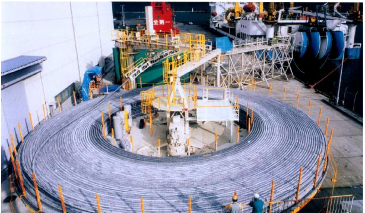
圖 5-2 已製造完成海底電纜
