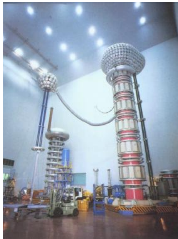
圖 5-8 高壓耐壓試驗設備
