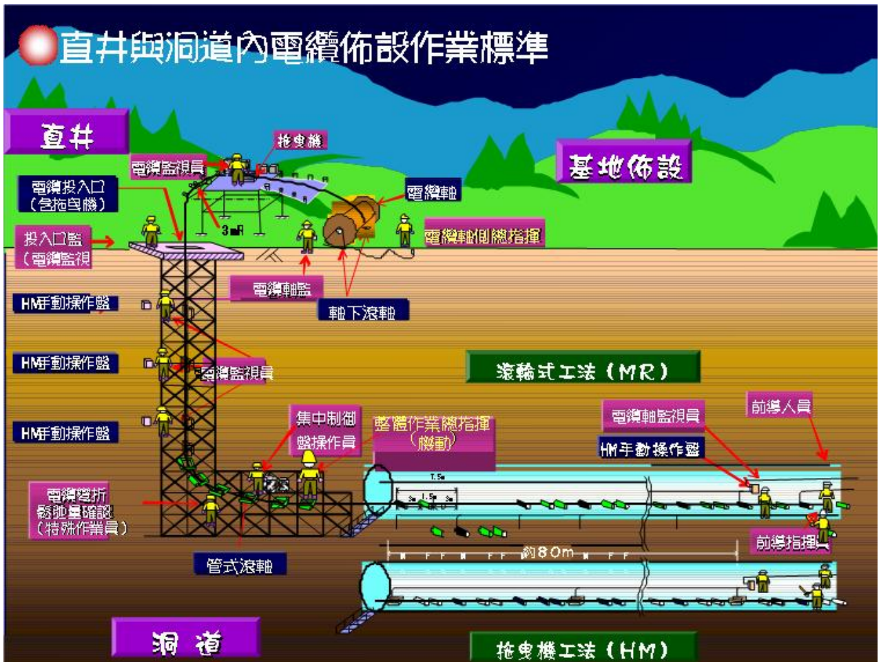
圖 3-10 直井與洞道內電纜佈設作業標準
