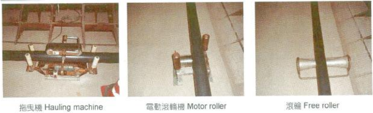
圖 3-6 延放線機具設備
