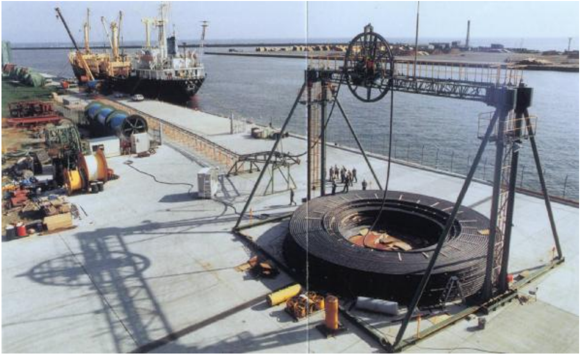
圖 5-7 海纜鎧裝完成後直接輸送至運輸船
