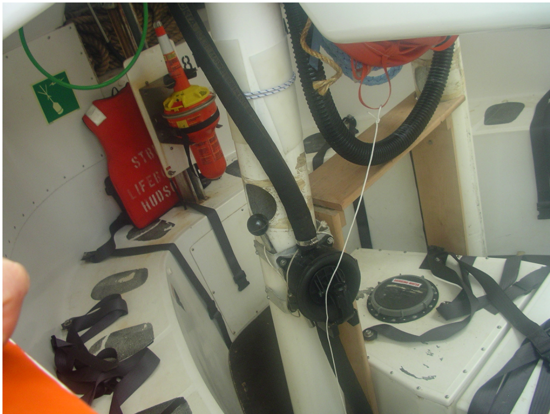
圖中左上之器具為無線電指位示標 EPIRB 及救生衣，為救難船之必要配備
