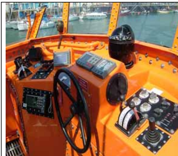
Serven 級全天候救難艇上甲板的二組操船系統(有別於本國搜救艇僅一組)
