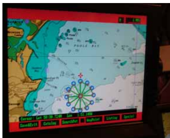
全天候 Mersey 級之搜救艇上的搜救電子海圖系統，螢幕上為扇形搜索圖。
