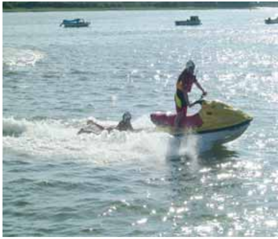
救難用之水上摩托車，後面另有加裝乙片墊板，利於救起水中人員
