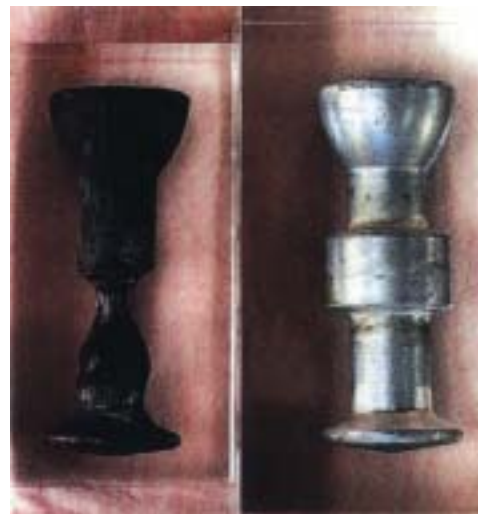
圖 10：PIN 腐蝕和 Zinc Sleeve 之比較
